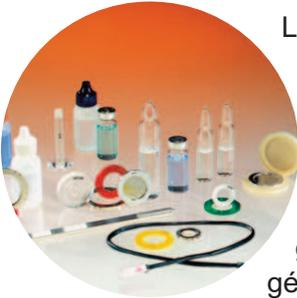
L'efficacité des instruments de mesure servant à identifier et à quantifier les émissions radioactives d'échantillons d'air, de sol, de sédiment ou d'eau doit être testée. Pour cela, un certain niveau de radioactivité sert de référence au calibrage. Tout échantillon nécessite un étalon radioactif de forme et de géométrie identiques.
