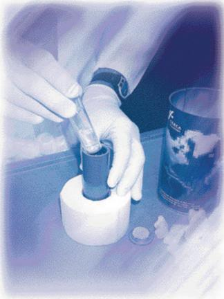
Les étalons doivent être manipulés avec beaucoup de précaution. Quand ils ne sont plus utilisés, ils doivent être stockés dans leur **emballage d'origine** ou dans un emballage adapté pour la radioprotection.
